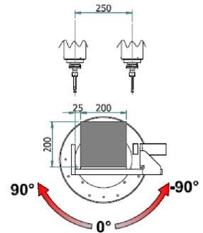
DIMENSIONES DE MECANIZADO A GRADOS DENTRO DE LA MAQUINA (3300MM)
